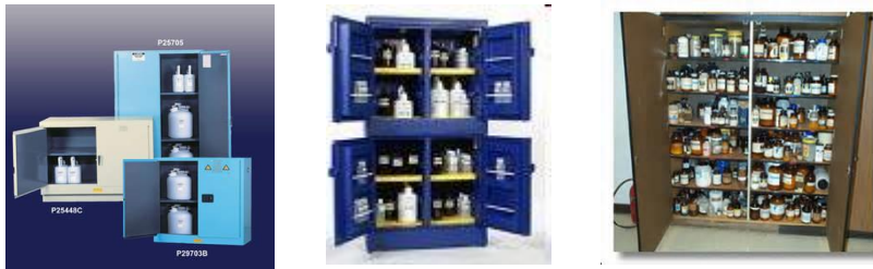
රූපය. 3.2: ගිනි ගන්නා සුළු ද්‍රව සහිත අල්මාරියක්, අම්ල සහිත අල්මාරියක් සහ අනෙකුත් රාක්ක පෙට්ටි 40,41
