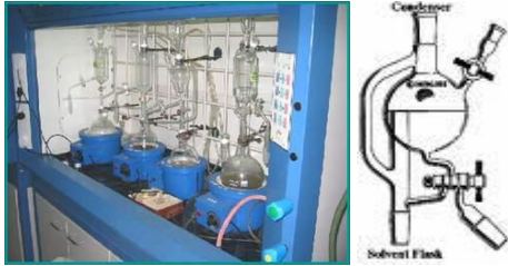
රූපය. 3.6: ස්ඵර ආසවන උපකරණ සහ ස්ඵර ආසවන උපකරණවල මුදුන් ශ්‍රේණියක් අඩංගු දුම් කුටීරය 45
